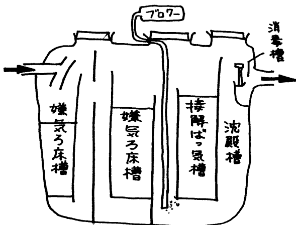
(合併浄化槽の図)
